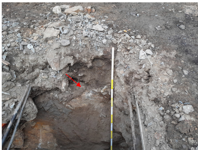
Kopaná sonda KS-1 (výkop pro patku osvětlení mezi kolejemi) granit - červená šipka
