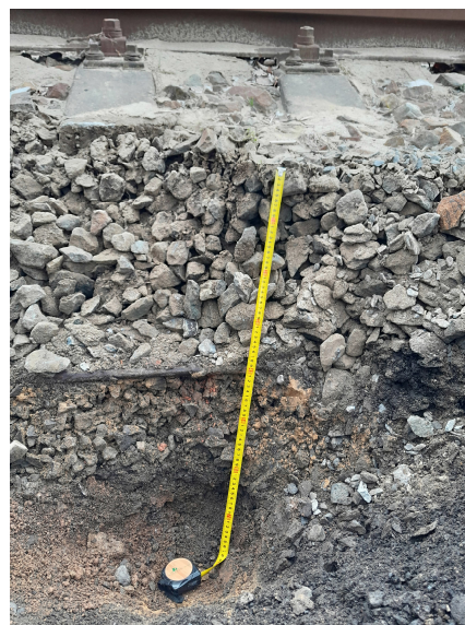
Kopaná sonda KS-10 (mezi kolejemi 1 a 2)
