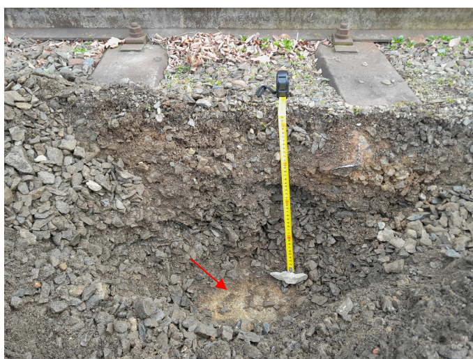
Kopaná sonda KS-2 (mezi kolejemi), povrch zvětralého granitu - červená šipka
